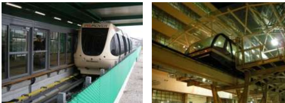
FIGURA 20 | A sinistra: Esempio di APM (Automated People Mover) urbano con trazione a fune, a Pisa; a destra: Esempio di APM urbano con trazione a fune, a Venezia
