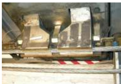
FIGURA 22 | Esempio di ammassamento del veicolo alla fune nell'impianto a fune di Zurigo (centro città-aeroporto)
